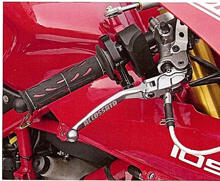
Über die biegsame Welle kann der Bremspunkt nachjustiert werden
