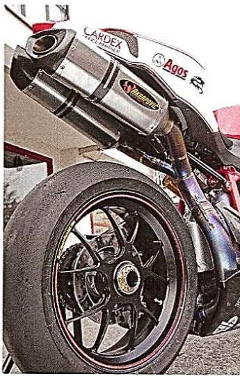
Spezielle Akrapovic-Auspuffanlage mit fetten Titankrümmern. Hier sind Slicks montiert
