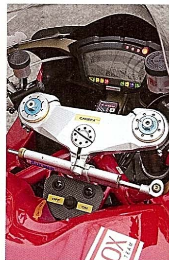
Zwischen Gabelbrücke und Cockpit die Schaltautomat-Elektronik. Am Tank der Schalter für die Zündung
