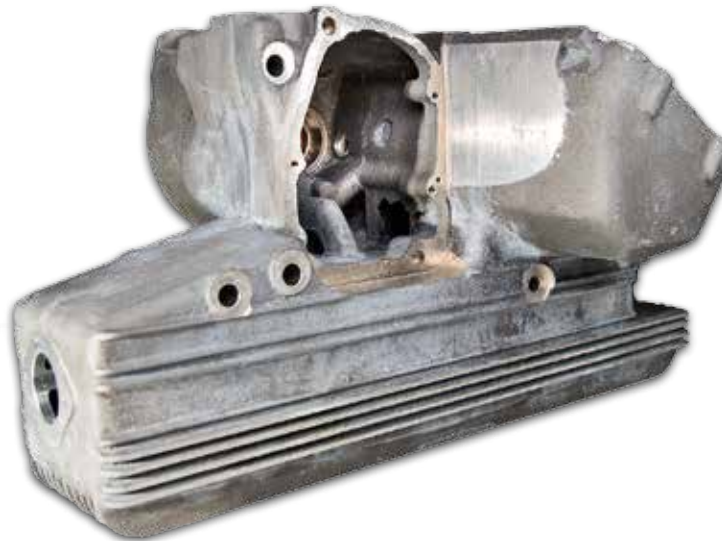
Ett hemligt specialgjuteri gjuter sedan de olika delarna. Topplocket till vänster kommer färdigbearbetat till Giuseppe som har modifierat toppen till fyrventils-drift. Slutbearbetningen av motorblocket görs i garaget.
