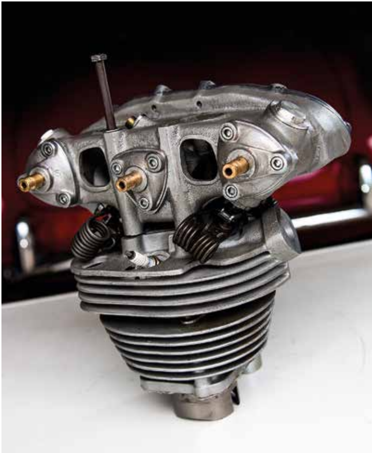
Till vänster: En tvåcylindrig MV-motor på 350 kubik som Ioannoni byggde 2004. Till höger: En MV-fyra på 500 kubik. Nedan: Topp och cylinder till en Ducati 125a. Här har Giuseppe gjort allt själv. På frågan varför han byggde den blir svaret kort och gott "Bara för att det var roligt."
