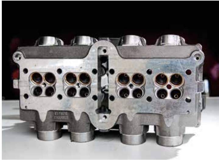
Ett hemligt specialgjuteri gjuter sedan de olika delarna. Topplocket till vänster kommer färdigbearbetat till Giuseppe som har modifierat toppen till fyrventils-drift. Slutbearbetningen av motorblocket görs i garaget.
